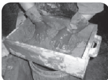
Filtración del pelambre.
