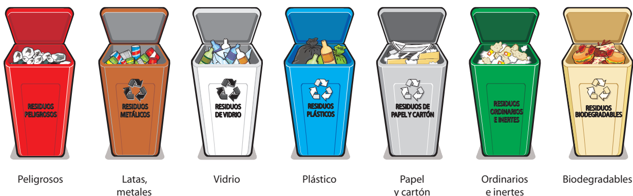
Figura 13. Recipientes utilizados para separación de los residuos sólidos y su Código de Colores
